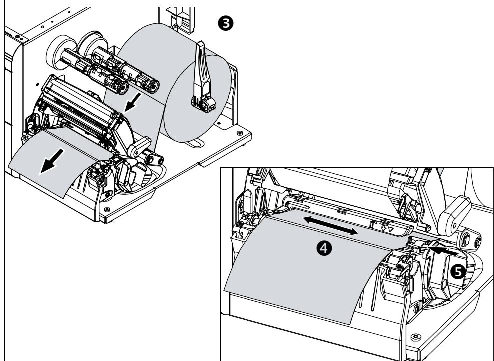
Loading Ribbon/安装碳带/安装碳带/ローディングリボン/Загрузочная лента/
