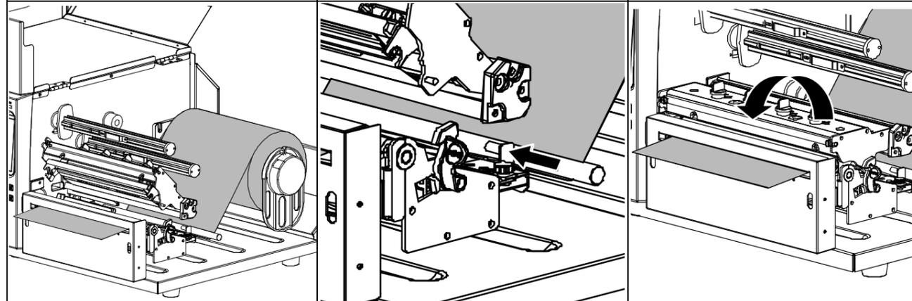
(4) Протяните конец носителя через направляющую носителя и датчик носителя и поместите его на бумагоопорный валик.
