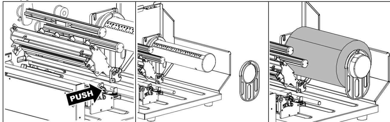
(1) Нажмите рычаг освобождения печатающей головки, чтобы открыть механизм печатающей головки.
