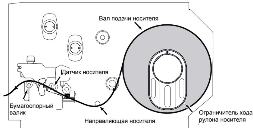
(7) Пользуясь дисплеем на лицевой панели, задайте тип датчика носителя и откалибруйте его. См. раздел «Калибровка датчика носителя».
