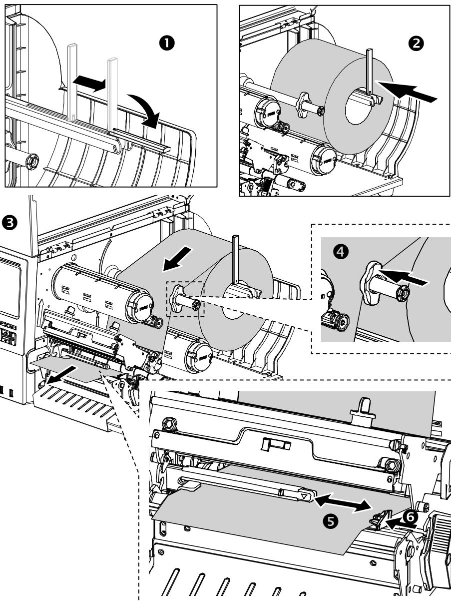
Loading Ribbon/安装碳带/安装碳带/ローディングリボン/Загрузочная лента/
