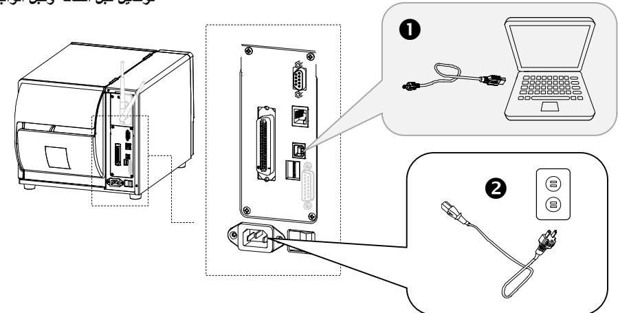
Turn on the Power/開啟电源/开启电源/電源を入れる/Включение принтера/Schalte den Strom an/Allumer l'appareil/Conectar la alimentación/Accendi il potere/
