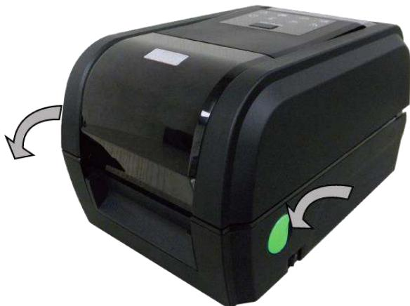
1. Откройте верхнюю крышку принтера, потянув рычаги для открытия верхней крышки, расположенные по бокам принтера, и откиньте крышку вверх до упора.
