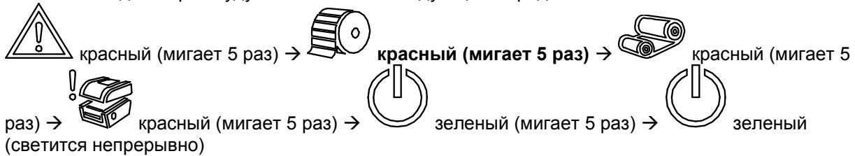
4. Принтер откалибрует датчик, измерит длину этикетки и распечатает внутренние настройки, а затем перейдет в режим дампа.
