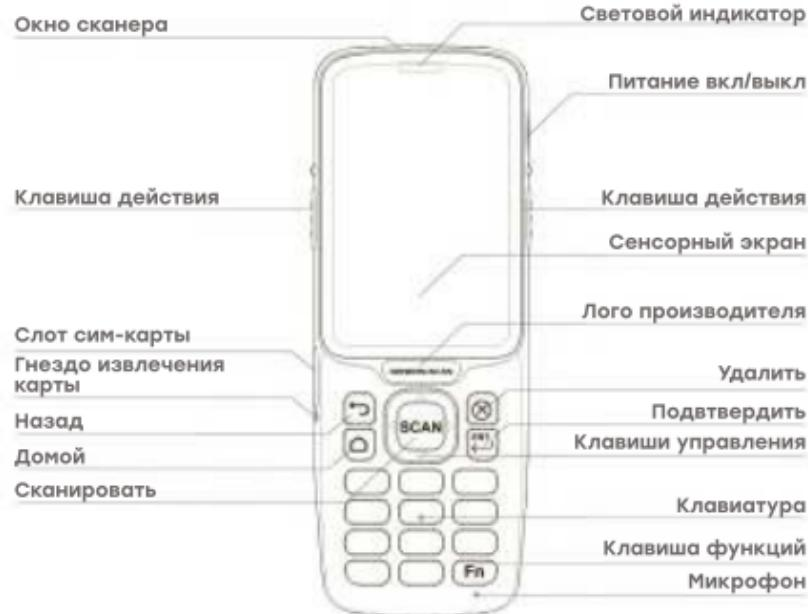
Клавишей **Fn** можно переключать цифры, заглавные и строчные буквы и функциональные клавиши. В верхнем углу экрана отображается текущий вариант работы.
