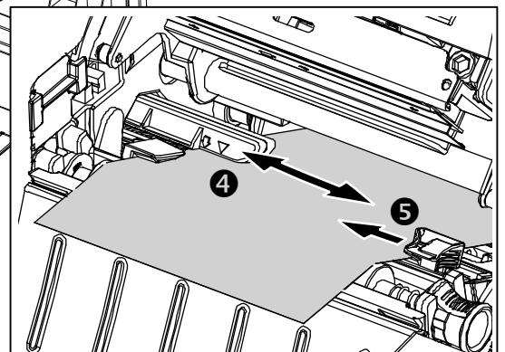
Loading Ribbon/安装碳带/安装碳带/ローディングリボン/Загрузочная лента/
