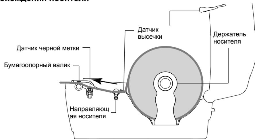
(7) Используя кнопку «Menu» (Меню) или «Diagnostic Tool» (Программу диагностики), задайте тип датчика носителя и откалибруйте выбранный датчик. (Запустите «Diagnostic Tool» (Программу диагностики). → Перейдите на вкладку «Printer Configuration» (Конфигурация принтера). → Нажмите кнопку Calibrate Sensor (Калибровка датчика). Для получения дополнительной информации см. краткое руководство по Утилите диагностики.
