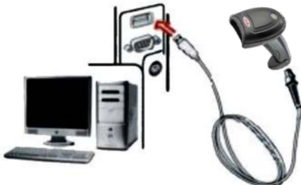
Рисунок 2. Подключение сканера к ПК
