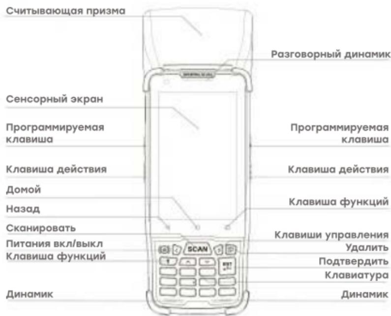
Клавишей **Fn** можно переключать цифры, заглавные и строчные буквы и функциональные клавиши. В верхнем углу экрана отображается текущий вариант работы. Клавиши направления **вверх** и **вниз** могут регулировать громкость после переключения клавиши **Fn** в соответствующий режим.
