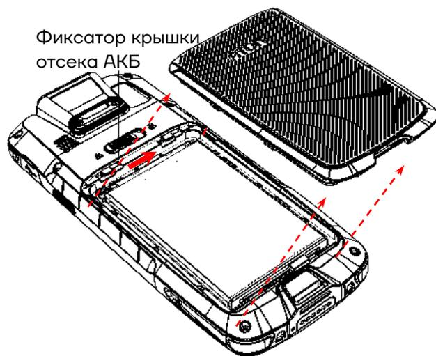
Рисунок 5. Отделение крышки отсека для АКБ от корпуса
