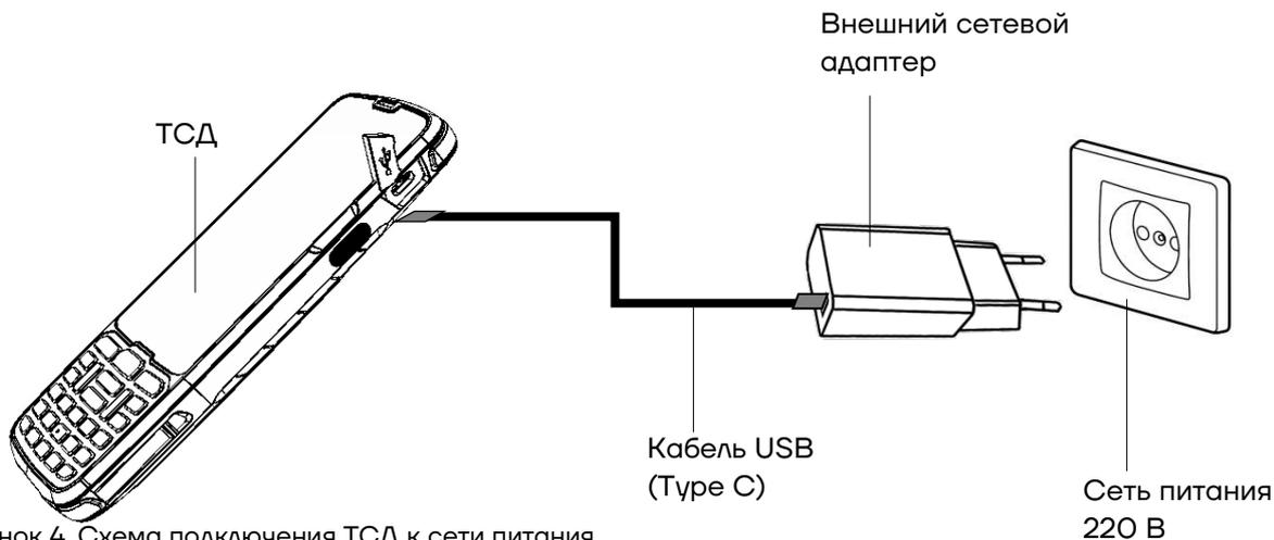
Рисунок 4. Схема подключения TSD к сети питания
