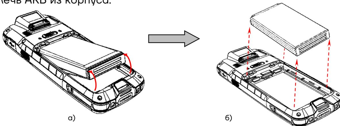
Рисунок 6. Извлечение аккумулятора:
