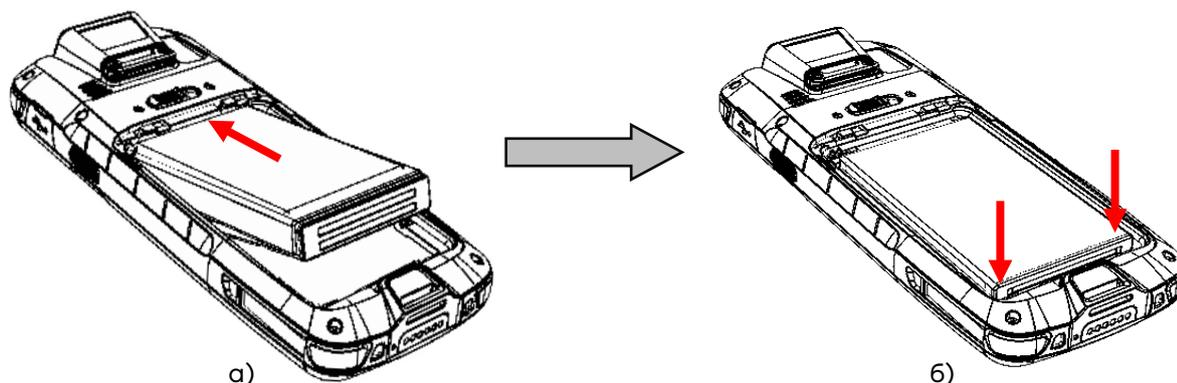
Рисунок 7. Установка АКБ:
